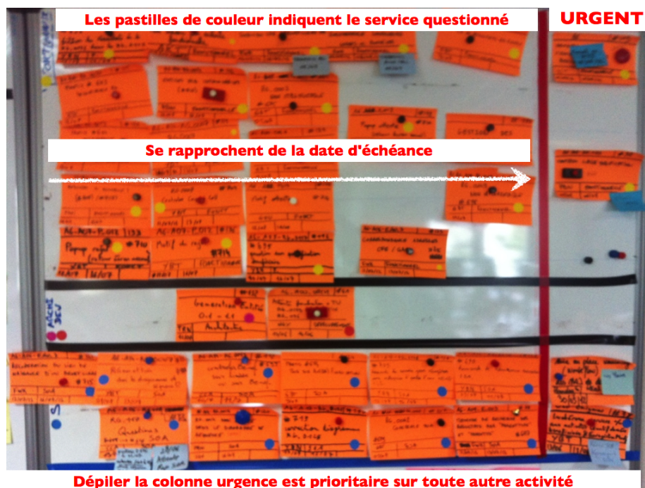
FIGURE 5.15 – Tableau de suivi des obstacles
